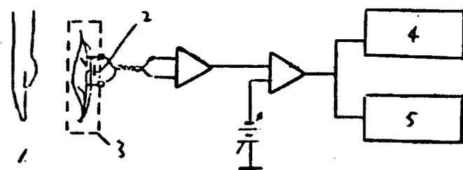
图4: 一种生物探测测量系统示意图, 其中: 1. 受试人; 2. 样品; 3. 容器; 4. 示波器; 5. 记录仪
