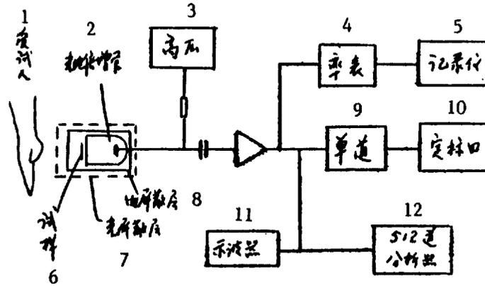
图7: 光量子探测器系统示意图.
